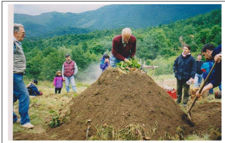
Si fa un ulteriore strato di copertura con terriccio. Sui fianchi del cono si fanno dei buchi e si inizia ad accendere il fuoco.
